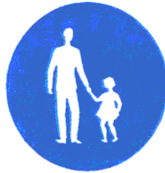
(P - 55) Οδός υποχρεωτικής διεύλευσης πεζών, (απαγορευμένης της διεύλευσης άλλων εκτός πεζών, οχημάτων άμεσης ανάγκης και οχημάτων για την είσοδο - έξο- δο σε παρόδιες ιδιοκτησίες).
